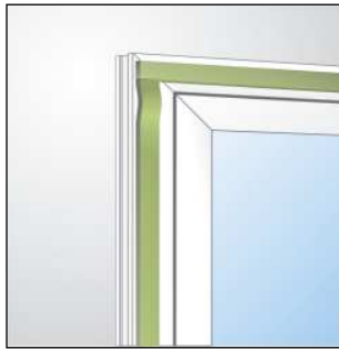
Bild 1: Eckauslegung bei der Fenstermontage
