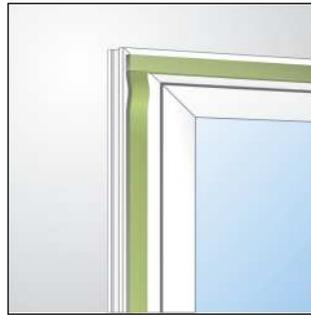
Bild 1: Bandverlegung bei der Fenstermontage
