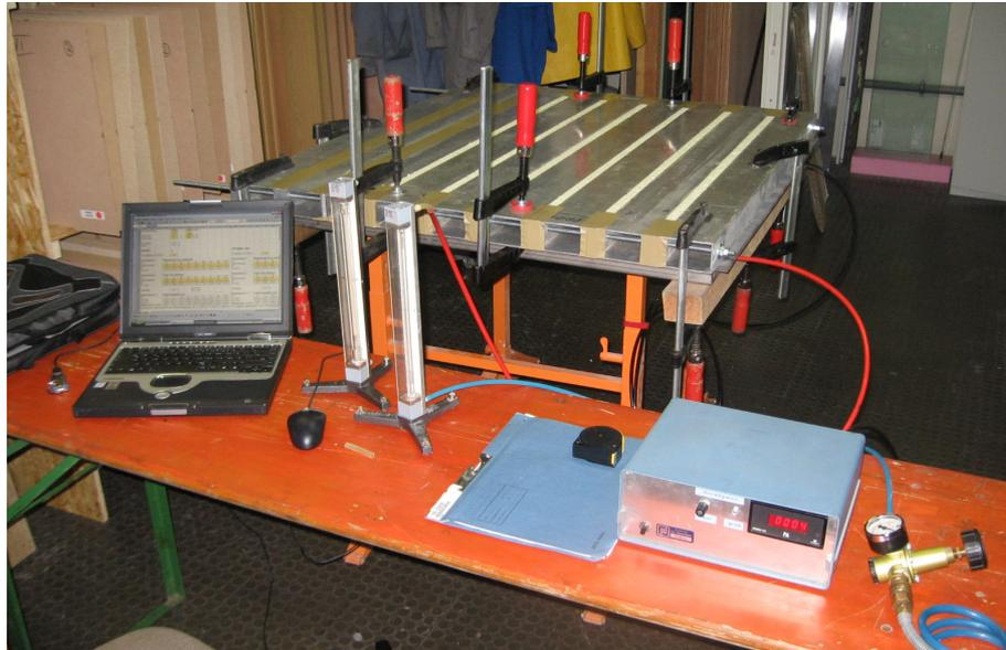
Abbildung 2 Messeinrichtung mit Durchfluss- und Druckmesseinheit.
