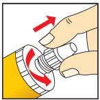
Kartusche aufschrauben und Deckel entfernen.
