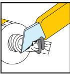
Verschlussfolie mit einem Messer durchtrennen und Kappe entfernen. Kartusche kurz anpressen bis aus den beiden Öffnungen jeweils weißes und schwarzes Material austritt. Dieses Material nicht verwenden.
